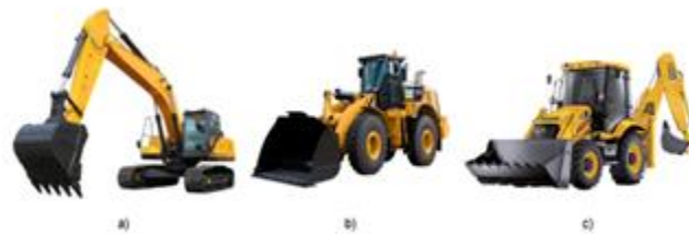
Fig. 2. a). Backhoe excavator, b). Loader excavator, c). Backhoe-loader excavator
