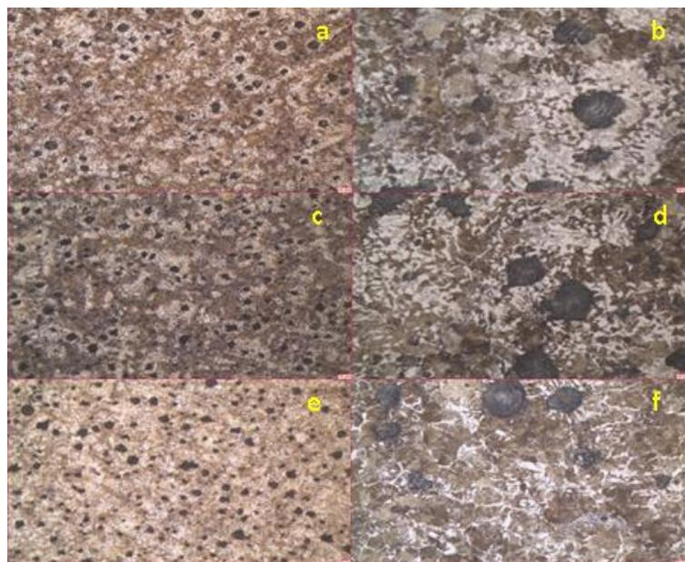
**Figure 2.** Microstructures of austempered camshaft; austempering at, 30 min., a) 100X, b) 500X; 90 min., c) 100X, d) 500X; 90 min., e) 100X, f) 500X
